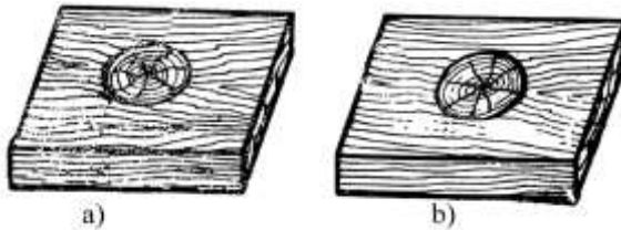
Şəkil 11. Əhatə edən oduncaqlı bitişmə dərəcəsiindən asılı olaraq düyünlərin növləri (sxem): a – bitişmiş, b – bitişməmiş
