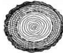
Şəkil 44. Ağac parçasının faner zonası (ştrixləndirilmiş)
