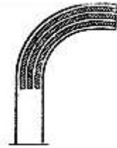
Şəkil 47. Daraqvari mişarlanıb əymə üsulu ilə hazırlanan pəstahlar
